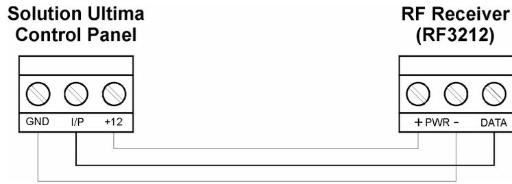
图 1: 无线接收机 (RF3212) 接线图
